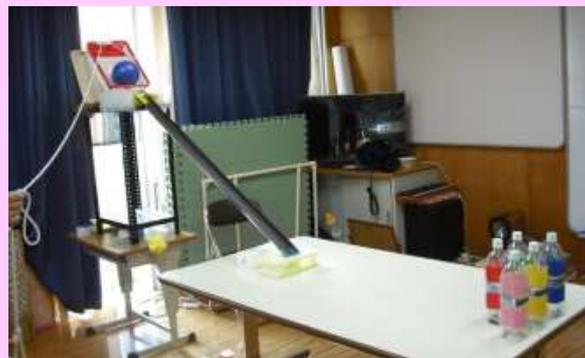
紐を引っ張ると、わずかな力でもボールが転がるように工夫しています。ボールの転がる様子やピンの倒れる様子が見えるように左右どちらからでも紐が引っ張れるようになっています。
